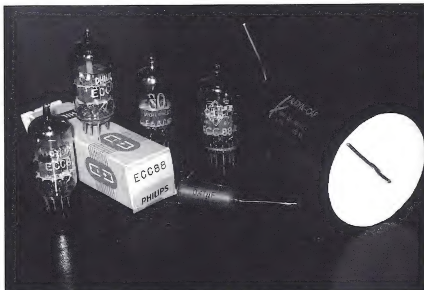
Enkele toegepaste componenten: Philips ECC88's, ERO MKT koppelcondensatoren en Audyn MKP uitgangscapacitoren.
